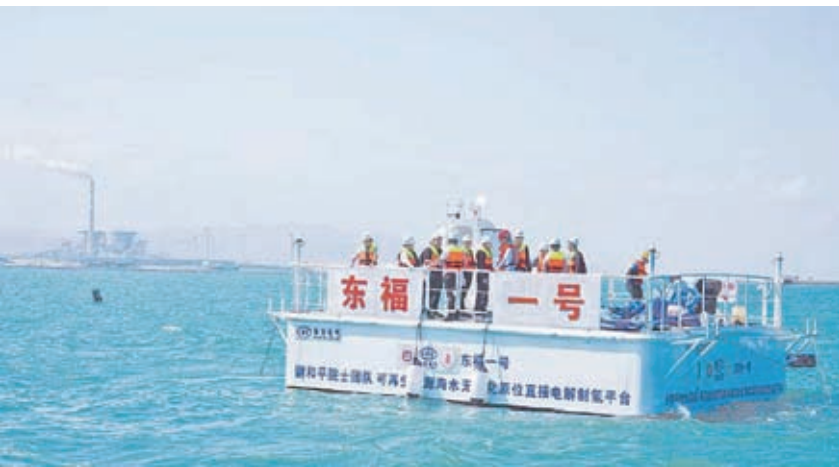
海水原位直接電解制氫技術海試現場(東方電氣福建創新研究院有限公司供圖)
